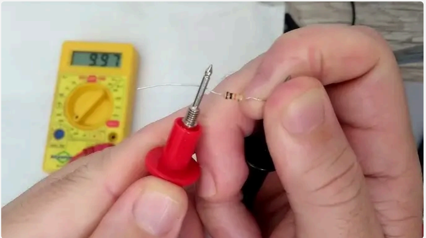
Medir o resistor FORA do circuito
